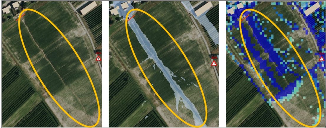
Abb. 2: Erosionsschäden lassen sich nicht nur kurz nach einem Ereignis beobachten, sondern zeigen sich auch gut in Luftbildern (hier: Reinacherweg in Efringen-Kirchen).
